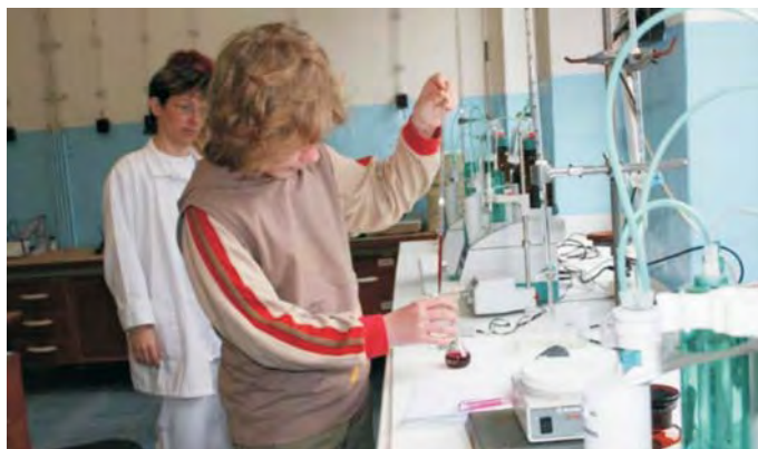
▲ Dominik pripravuje vzorku, na ktorej si vyskúšal acidometrickú titráciu za použitia automatickej byrety Dosimat 775. Foto: P. Hudec
