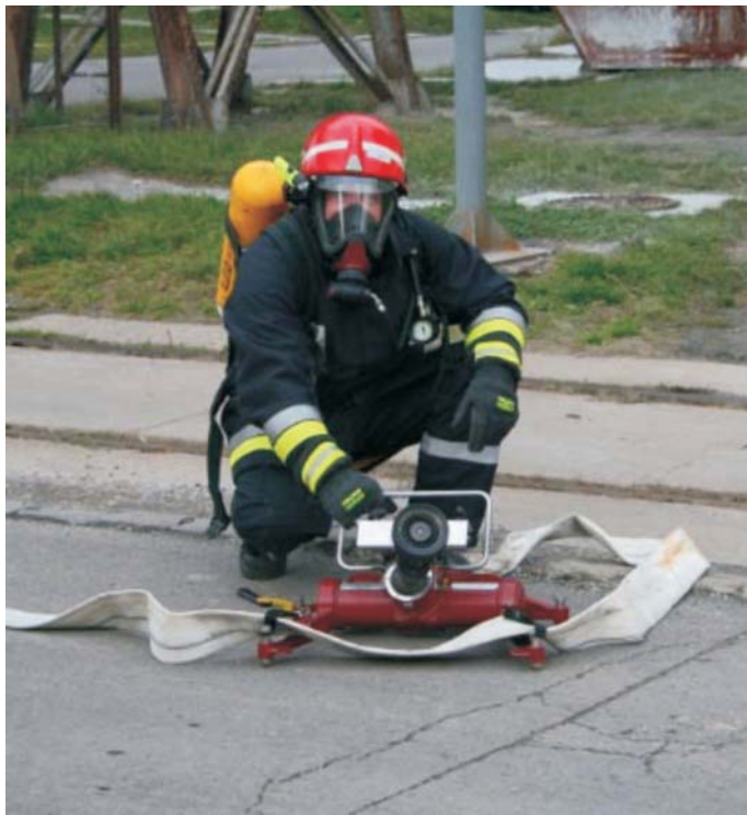
▲ Bezobslužný prenosný monitor OZZIE nahrádza prácu hasiča na najnebezpečnejšom mieste. Bol výborným pomocníkom i počas zásahu vo VOP pred rokom. Foto: P. Hudec
